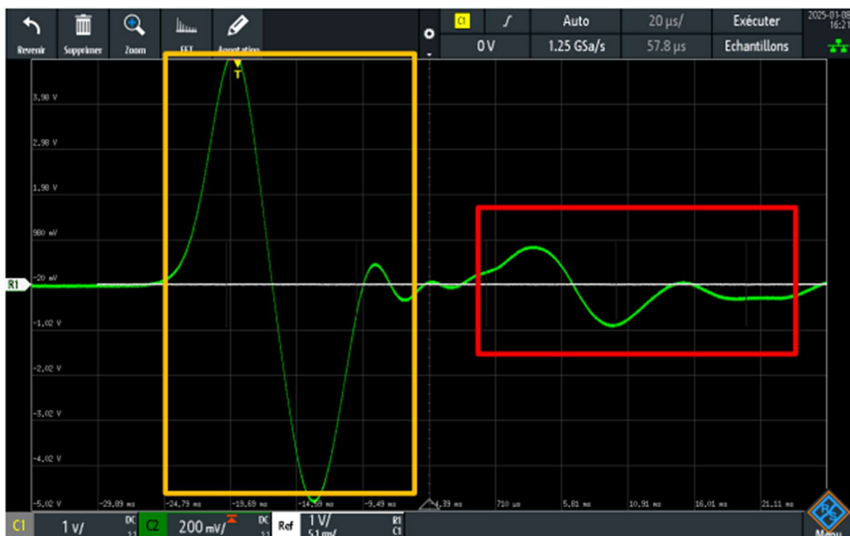
Figure 2: Capture d'écran de l'oscilloscope en terminaison ouverte à x=7
