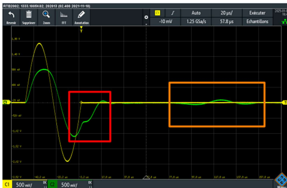
Figure 5: Capture d'écran de l'oscilloscope en terminaison court circuit à x=6
