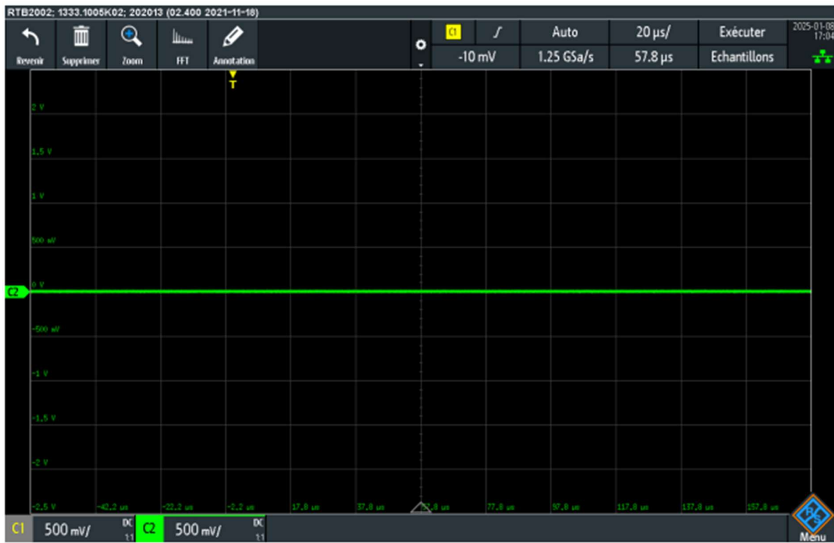
Figure 8: Capture d'écran de l'oscilloscope en terminaison court-circuit à x=20
